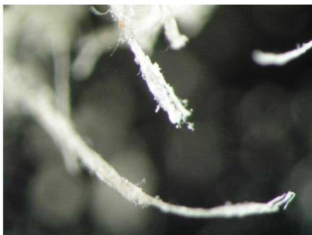
Particolare di fibra di amianto (63x)
